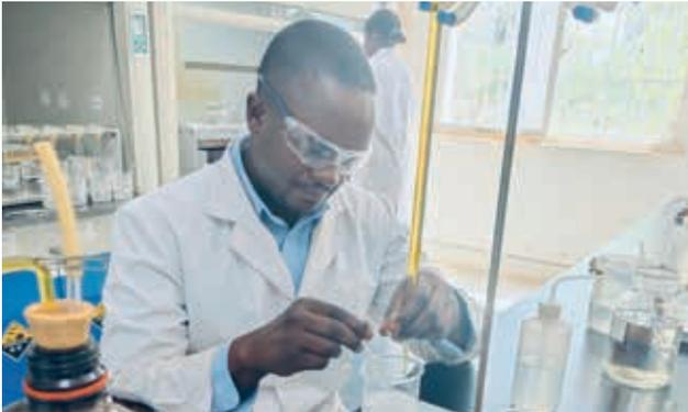
盧阿拉巴銅冶煉實驗室採用滴定法檢測銅精礦中的含Fe元素
